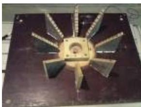
Nun fehlte noch die Primärspule, welche dann von uns angefertigt wurde. Hier ist die Halterung noch ohne Draht zu sehen; dieser wurde nach der Aufnahme eingefädelt.
