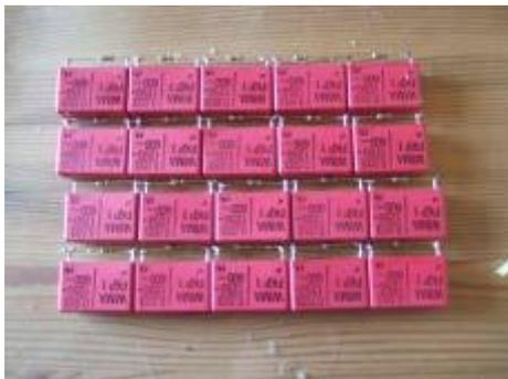
Zur Verwendung kamen „Wima Fkp1“-Kondensatoren, welche impulsfest und selbstheilend sind. Sie sind bis 600V (AC) spannungsfest und haben jeweils 33nF Kapazität. In diesem Stack verlötet sind 20 dieser Kondensatoren, was eine Spannungsfestigkeit von 12kV (AC) und eine Kapazität von 1,65nF ergibt. Dieses wurde nach folgender Rechnung ermittelt:
