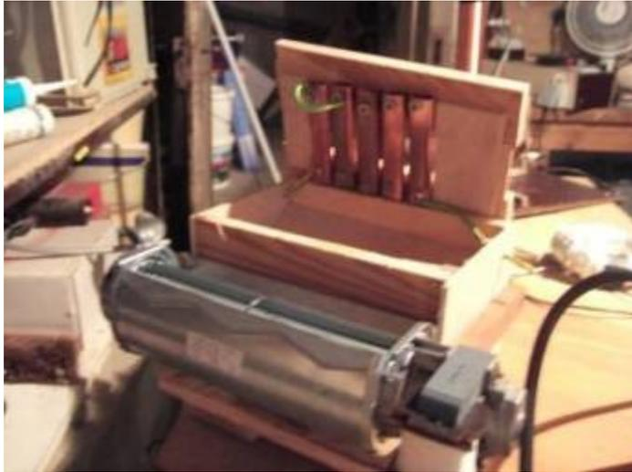
Dieses neue Modell wurde mit einem Walzen-Lüfter ausgestattet, welcher noch vorrätig war. Die Funkenstrecke besteht ebenfalls aus Kupferrohren. Auf dem Bild sieht man, dass eine Lücke überbrückt wurde. Als Faustregel gilt 1kV kann 1 mm Luftspalt überwinden. Mit dieser neuen Funkenstrecke. wurde dieser Aufbau aufgebaut.
