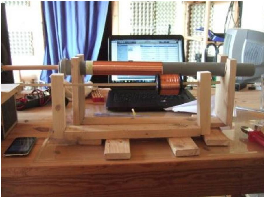
Die hier zu sehende Spule hat einen Durchmesser von 40mm und ist auf der Länge von 24cm bewickelt, was ein Aspektverhältnis von 1:6 ergibt. Die Wickelvorrichtung wurde von mir extra für diese Spule hergestellt, sie besteht aus einer Halterung, in der sich die Spule drehen kann, einem separaten Halter für den Wickeldraht, und besitzt zusätzlich einen Antrieb über eine Bohrmaschine, deren Drehzahl reguliert werden kann. Die Drahtstärke beträgt 0,4mm.
