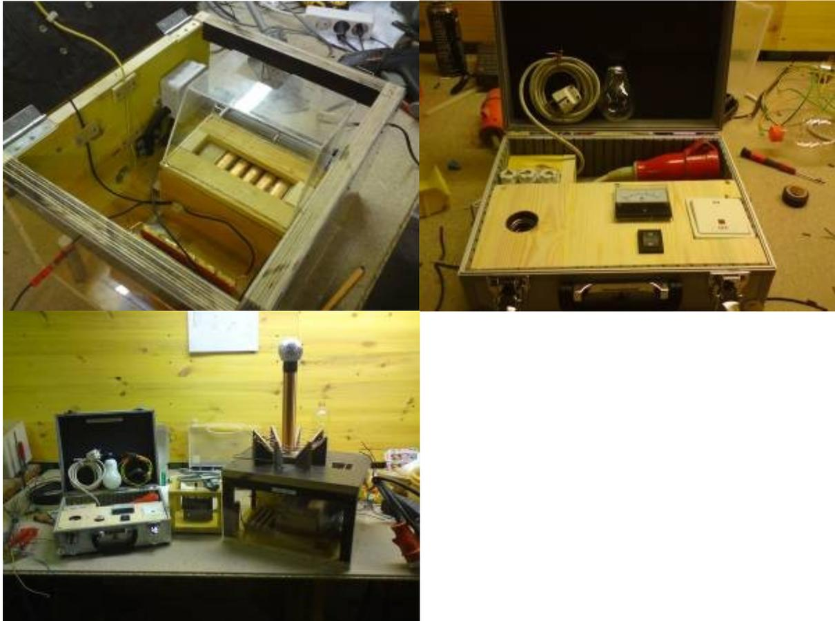
Der Deckel der Spuleneinheit ist mit Scharnieren an der Rückseite befestigt und lässt sich somit aufklappen. In der aktuellen Form (STGC 1.3) wurde der hier zu sehende separierte Einspeise-Trafo wieder in das Hauptgehäuse eingebaut, um möglichst hohe Anfasssicherheit zu gewährleisten. Außerdem mussten wir eine kleine Änderung des Schaltplans vornehmen, da wir Schwierigkeiten, hatten die Teslaspule nach dem Umbau wieder funktionsfähig zu bekommen. Unser neuer Schaltplan sieht wie folgt aus.
