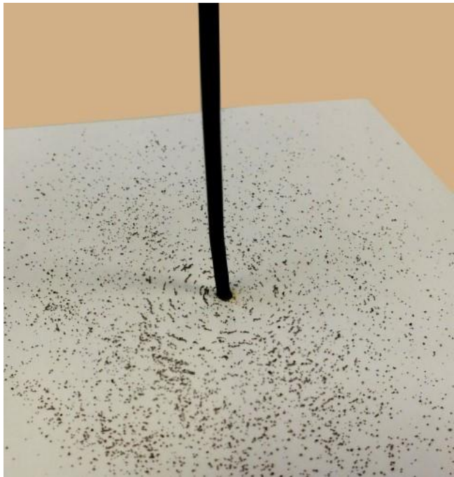
Magnetfeld um einen stromdurchflossenen Draht (Foto: Simon)
