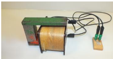
Keine Induktionsspannung bei konstantem Magnetfeld (Foto: Simon)
