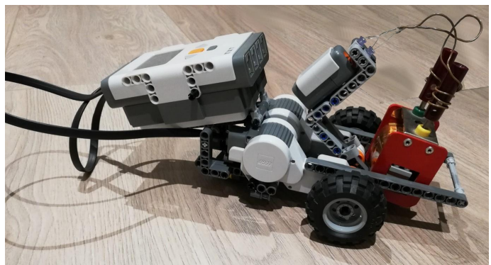
Auto mit waagrecht stehender Induktionsspule (Bild: Fin)
