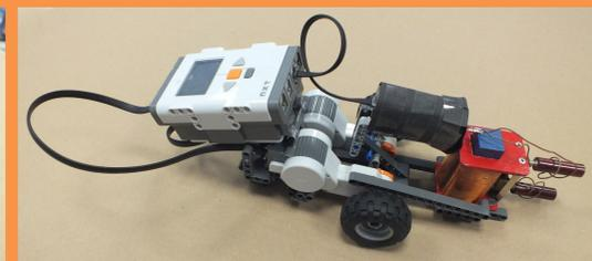
Das neue Modell Prototyp 2 hatte die Spule waagrecht. Es hatte aber keine Abdeckung für die Lampen, wodurch außenstehendes Licht den Sensor ablenkte. Die Steuerungseinheit diente als Gegengewicht für die Spule. Das Hinterrad war aber nicht ausgereift und knickte ein.
