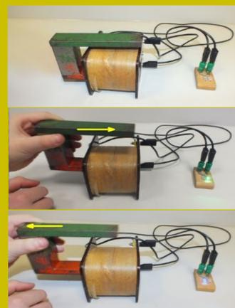
Nur ein sich änderndes Magnetfeld erzeugt eine Induktionsspannung!
