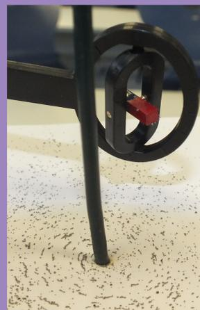
Wenn Strom durch eine Leitung fließt, bildet sich darum ein ringförmiges Magnetfeld. Wenn die Feldlinien durch die Spule kommen, wird bei Wechselstrom eine Induktionsspannung erzeugt.
